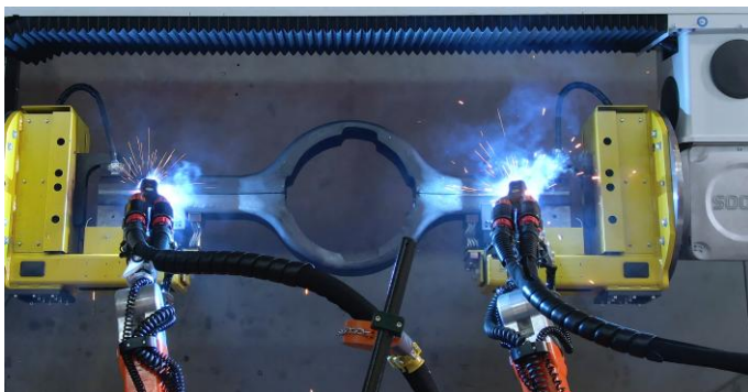
Bild 2: CLOOS hat das TANDEM-Schweißen vor über 30 Jahren erfunden und den Prozess seither kontinuierlich weiterentwickelt.
